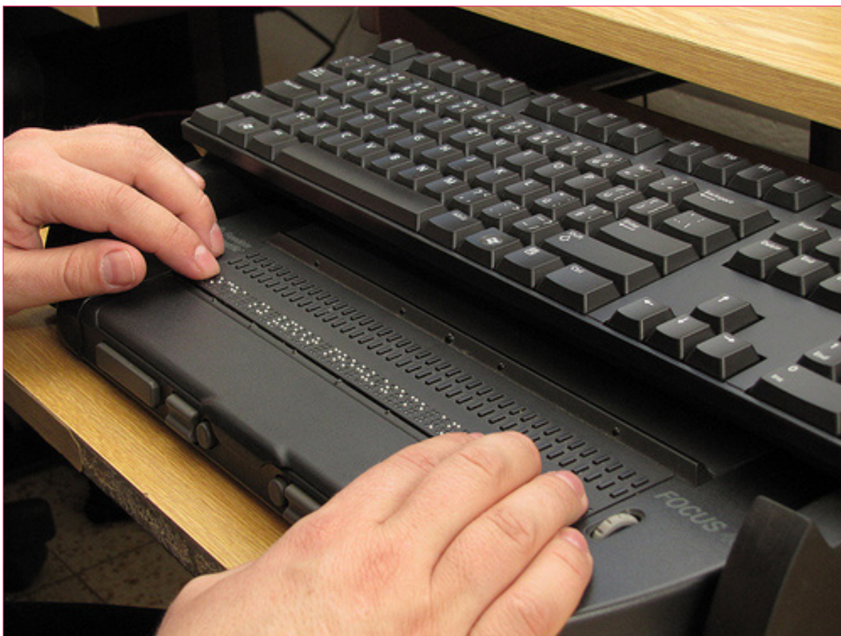
Obr. 4: Ukázka práce na Braillovém řádku (po připojení k počítači) s možností využití ke studiu učebního textu (text v základu je v elektronické podobě)
